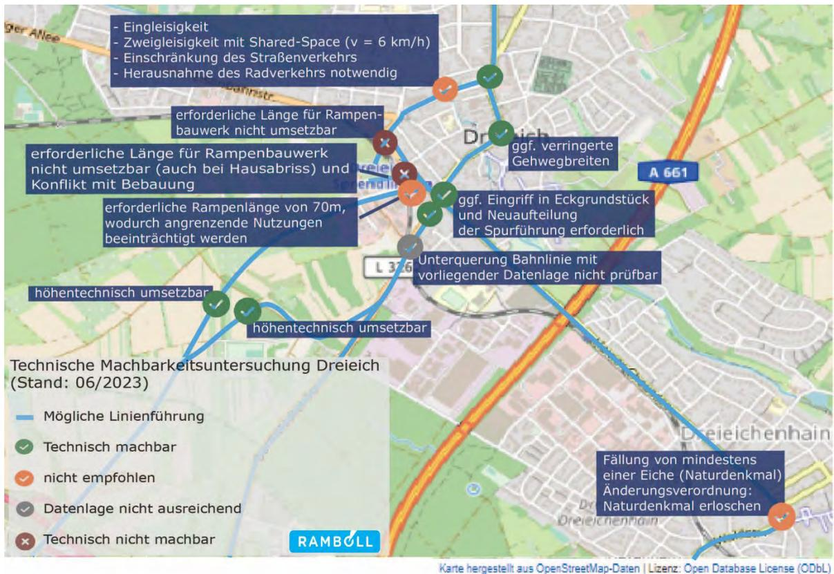
Abbildung 15 Streckenführung mit technischer Machbarkeit Dreieich
